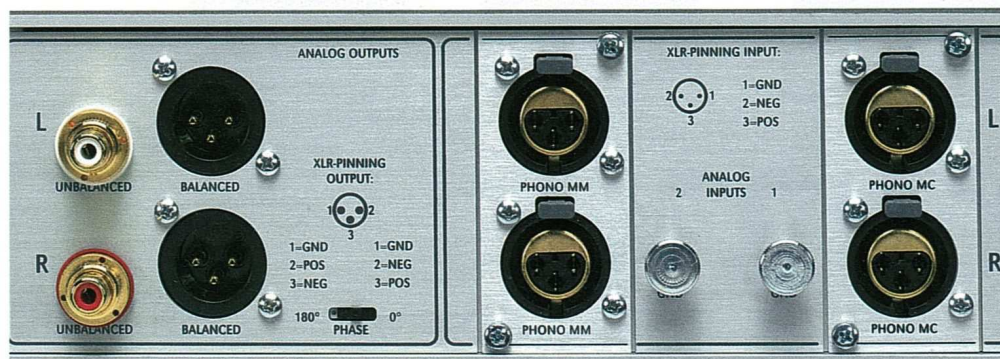
Ruhe bitte: Durch die symmetrischen Phono-Eingänge werden von außen auf die Kabel einwirkende Störgrößen wirkungsvoll ausgelöscht
