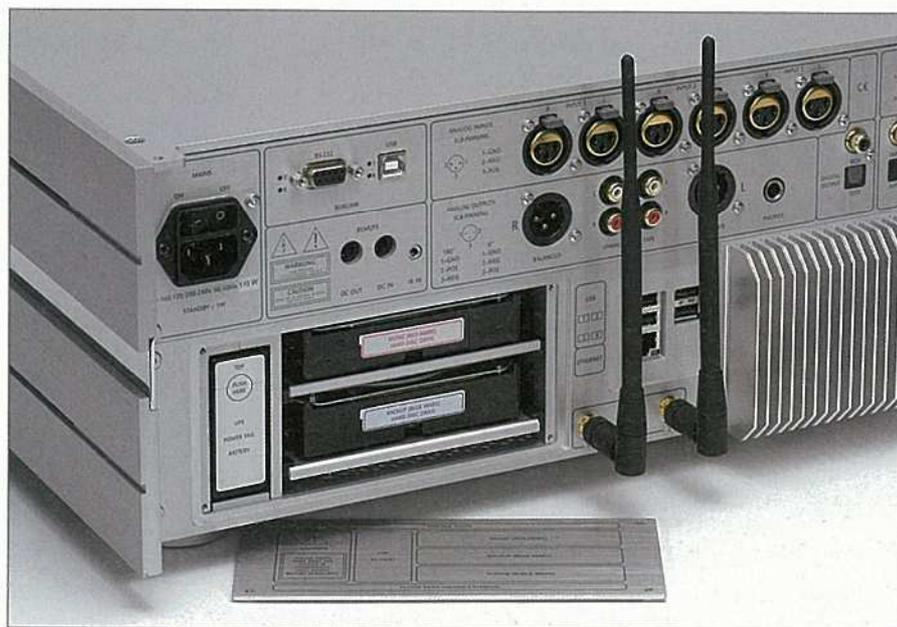
Safety first: Die Festplatten im RAID 1 sorgen ebenso für Datensicherheit wie die Pufferbatterie daneben. Rechts: die WLAN-Antennen
