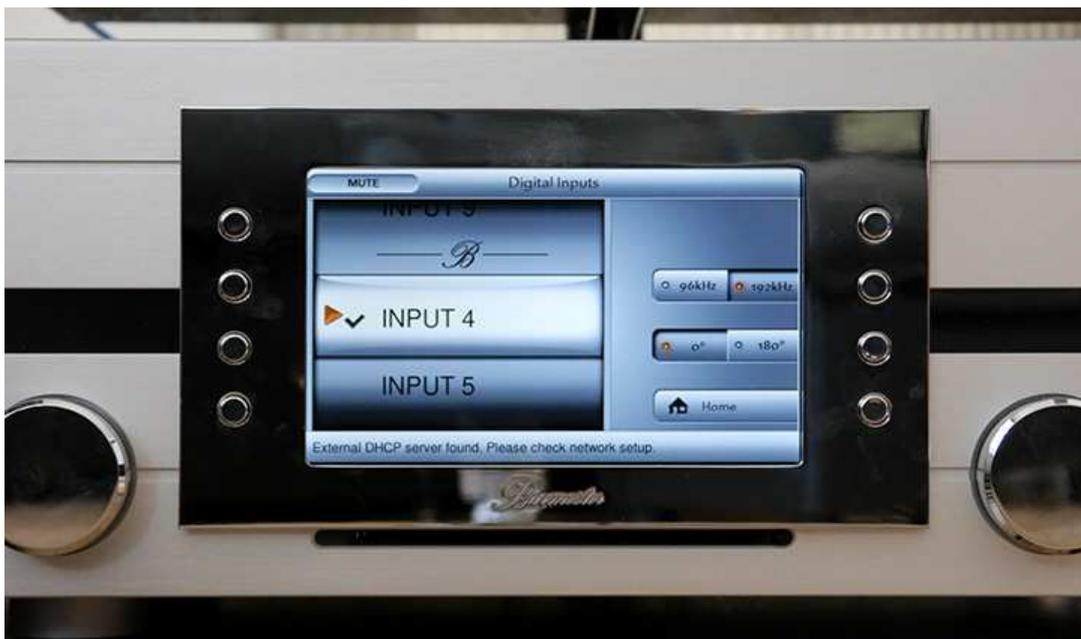
Der Bildschirm deutet die Bedienung visuell an. Die »Trommel« mit den Eingängen dreht man mit dem linken Drehregler. Die Funktionen, die bis zum Bildrand reichen, betätigt man mit den korrespondierenden Tastern.
