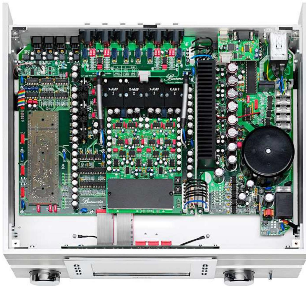
Burmesters 111 Musiccenter schützt die Musikdaten. Deshalb gibt es am Netzanschluss des riesigen Netzteils ein dickes Akkupack für eine unterbrechungsfreie Stromversorgung (oben rechts) – sie liefert im Notfall genügend Energie, um das System ordnungsgemäß herunterzufahren und so Datenverluste zu verhindern.
