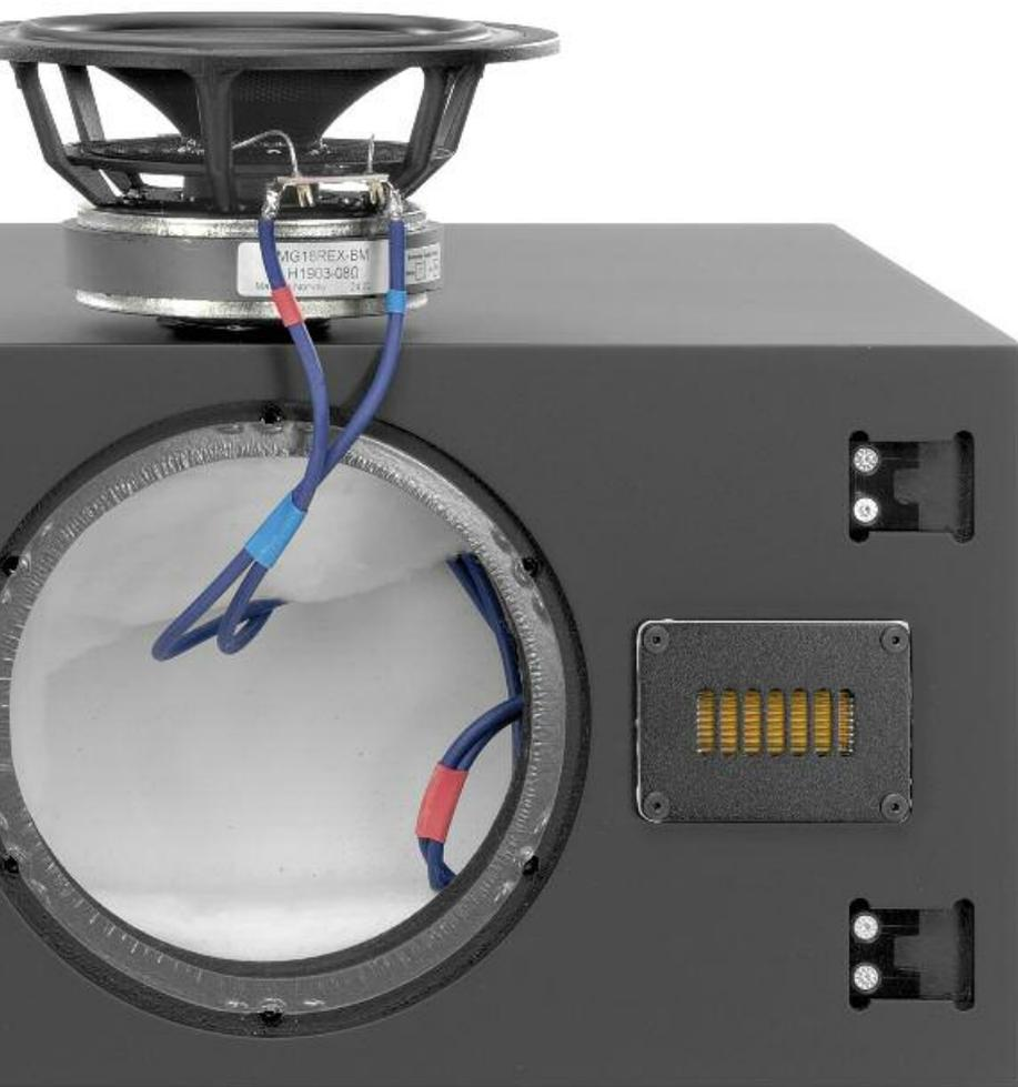
Oben: Die beiden 170 Millimeter breiten Tieftöner mit Glasfasermembranen sehen dem Mitteltöner zwar fast zum Verwechseln ähnlich, unterscheiden sich von diesem aber schon aufgrund ihres größeren Hubs und stärkeren Antriebs grundlegend. Bei der Innenverkabelung setzt Burmester auf relativ große Kabelquerschnitte, was angesichts einer Nennimpedanz von 4 Ohm und einer Nennbelastbarkeit von satten 180 Watt durchaus einleuchtet
