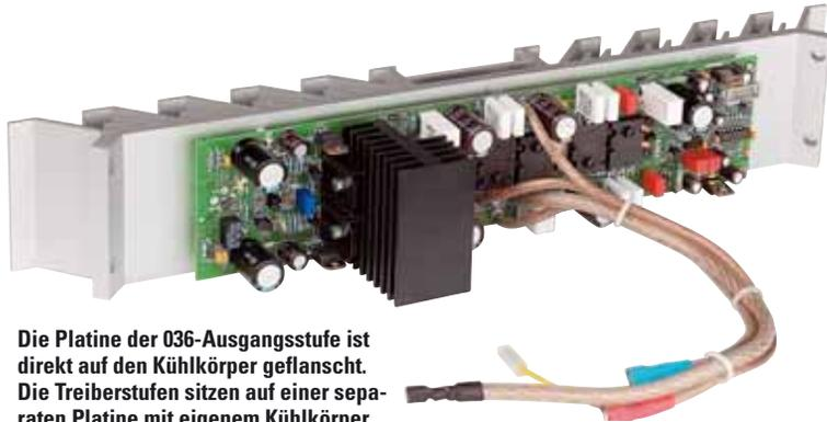
Die Platine der 036-Ausgangsstufe ist direkt auf den Kühlkörper geflanscht. Die Treiberstufen sitzen auf einer separaten Platine mit eigenem Kühlkörper, um ungestört arbeiten zu können
