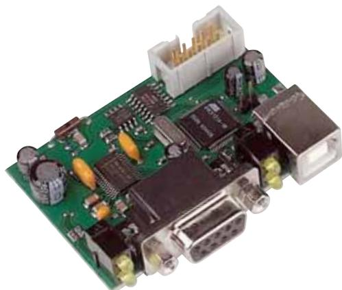
Diese kleine Platine verbindet die 035 mit modernen EDV-Schnittstellen. So lässt sich beispielsweise die Steuerungssoftware einfach updaten
