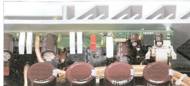
Das Kabel ist nicht umsonst so dick: Schließlich müssen da ein Spitzenstrom von 30 Ampere und (in der Mono-Version) 300 Watt Leistung ungehindert fließen können
