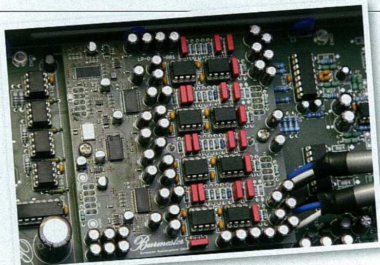
Die Operationsverstärker für die I/U-Konvertierung und Filterung sind gesockelt, weil sie im Spieler ausgemessen und gematcht werden.
