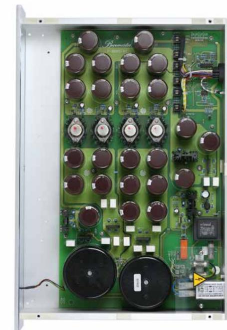
Einblicke in die 5er-Kombi des 808: Für die Fernbedienbarkeit des Vorverstärkers wurden feinste Burmester-Silver-Kabel im Kellergeschoss verlegt. Das extrem starke Netzteil des Mk5-Modells ist auch im offenen Zustand ein Musterbeispiel für schlichte Spitzenklasse.
